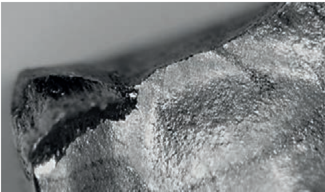
Tensão excessiva na pastilha causa ruptura.
