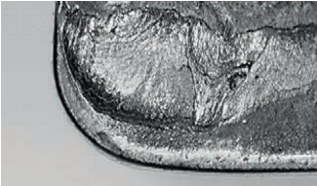
O cavaco quente que está sendo evacuado causa craterização na face inclinada da aresta de corte.
