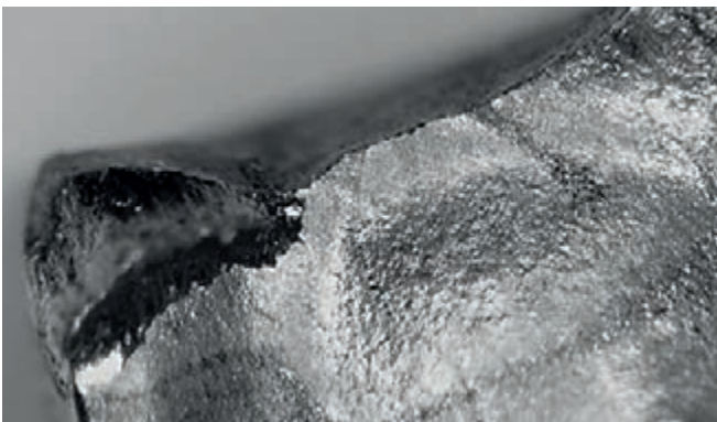
Tensão excessiva na pastilha causa ruptura.
